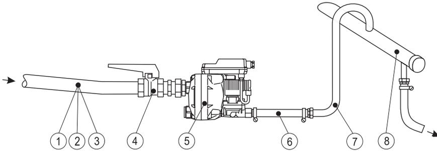
1. Zulaufrohr und Fitting mind. ½" (Innendurchmesser ≥ 13 mm (0.5"))!
