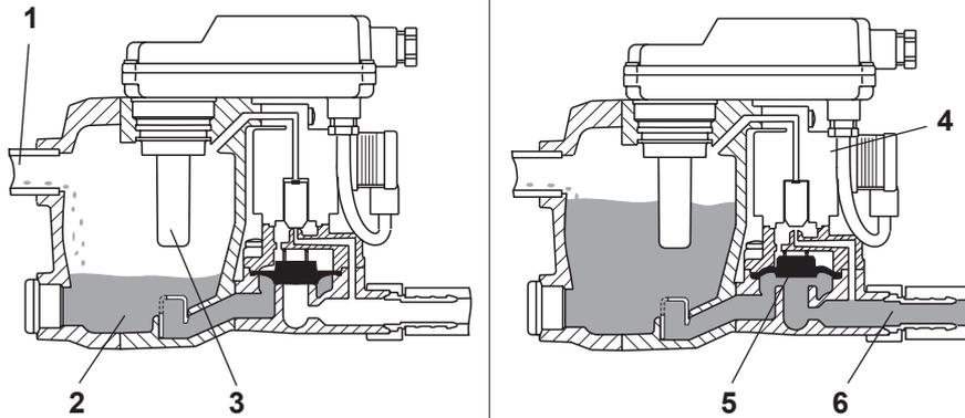
Das Kondensat strömt über die Zulaufleitung (1) in den BEKOMAT® und sammelt sich im Gehäuse (2). Ein kapazitiv arbeitender Sensor (3) erfasst permanent den Füllstand und gibt ein Signal an die elektronische Steuerung sobald sich der Behälter gefüllt hat. Das Vorsteuerventil (4) wird betätigt und die Membrane (5) öffnet zur Kondensatausschleusung die Ablaufleitung (6).
